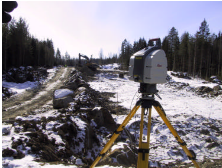
Laserskanner (Leica HDS3000) teetöömaal.
