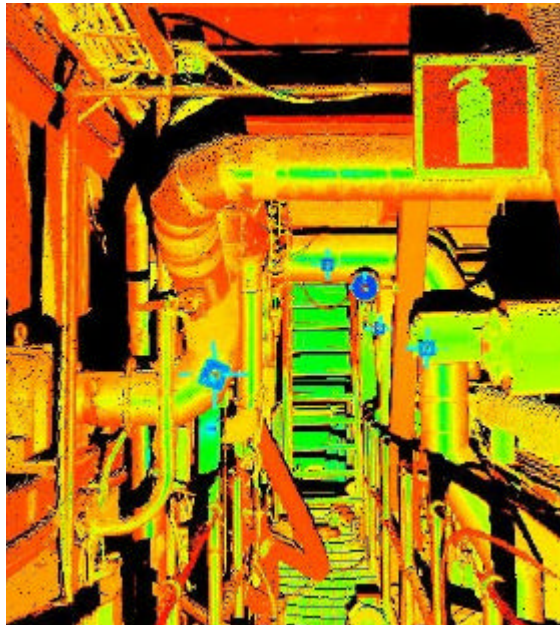
Tööstusettevõttest saadud punktipilv. Pildil näha olevad sinised laigud on punktipilvede ühendamisel kasutatavad tähised. Tööstusettevõtetes naturaalsete värvide kasutamane tavaliselt ei õnnestu, sest ruumid on liialt pimedad. Seega on otstarbekam kasutada tagasipeegelduva signaali intensiivsust.
